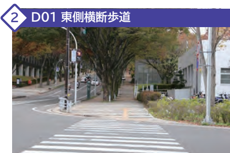
スロープに接続している通路に段差があります。一部段差解消がされていますが、角度が急であるため、注意してください。
