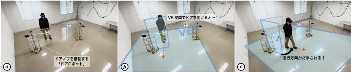
図 2. RedirectedDoors の概要 (a) ドアロボット 2 台がユーザの周囲で動き回ります。(b)(c) ドアを開ける動作を通して、ユーザの進行方向を誘導します。
