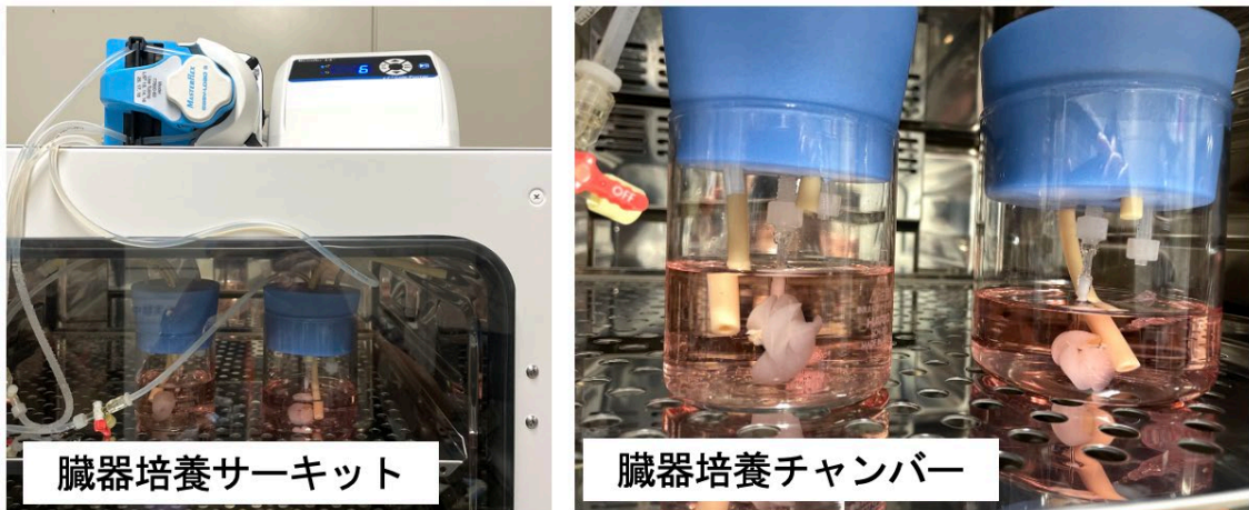
図 2. 肺再生用還流培養装置
