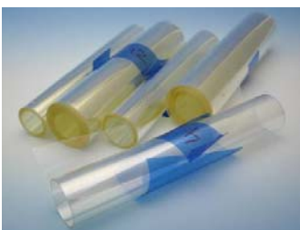
図5 有機溶媒に透明に分散するナノ粒子
