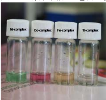
図5 有機溶媒に透明に分散するナノ粒子
