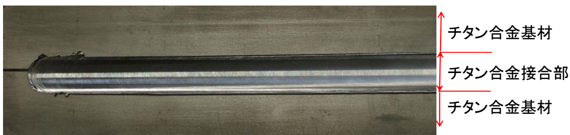
【写真】今回、開発したツールの接合試験結果 チタン合金の例
