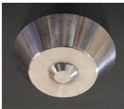
【写真】今回、開発した FSW ツールの先端部分
