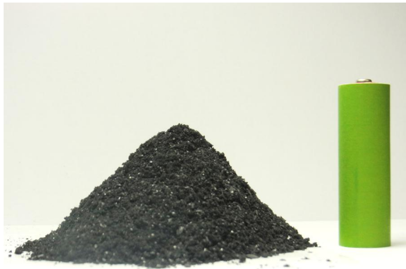
図2 乾燥させた約5グラムのグラフェン粉末(右は単三形電池)
