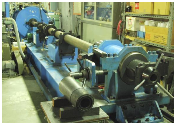
図 2: 衝突実験に使用した一段式火薬銃 (物質・材料研究機構)
