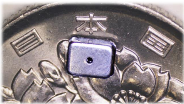
図 1 100 円玉の上に置いた MEMS エレクトレットマイクロホン
