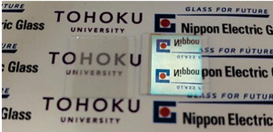
図 1 開発された透明で高屈折率な \text{TiO}_2 薄膜(左)とそれを用いた可視光ミラー (右)。
