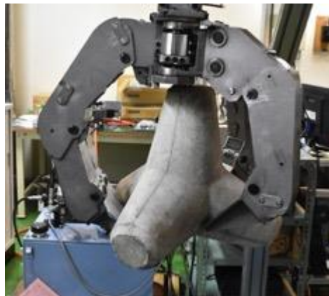
図4 相手の形に応じて指が曲がるので複雑な形状の重量物も安定して把持できる
