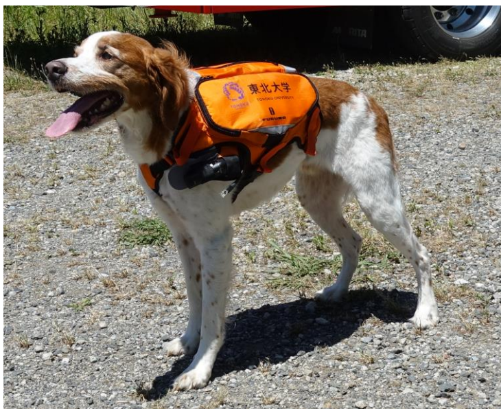
図1. 災害救助犬による人の捜索を遠隔モニタリングする新型サイバー救助犬スーツ
