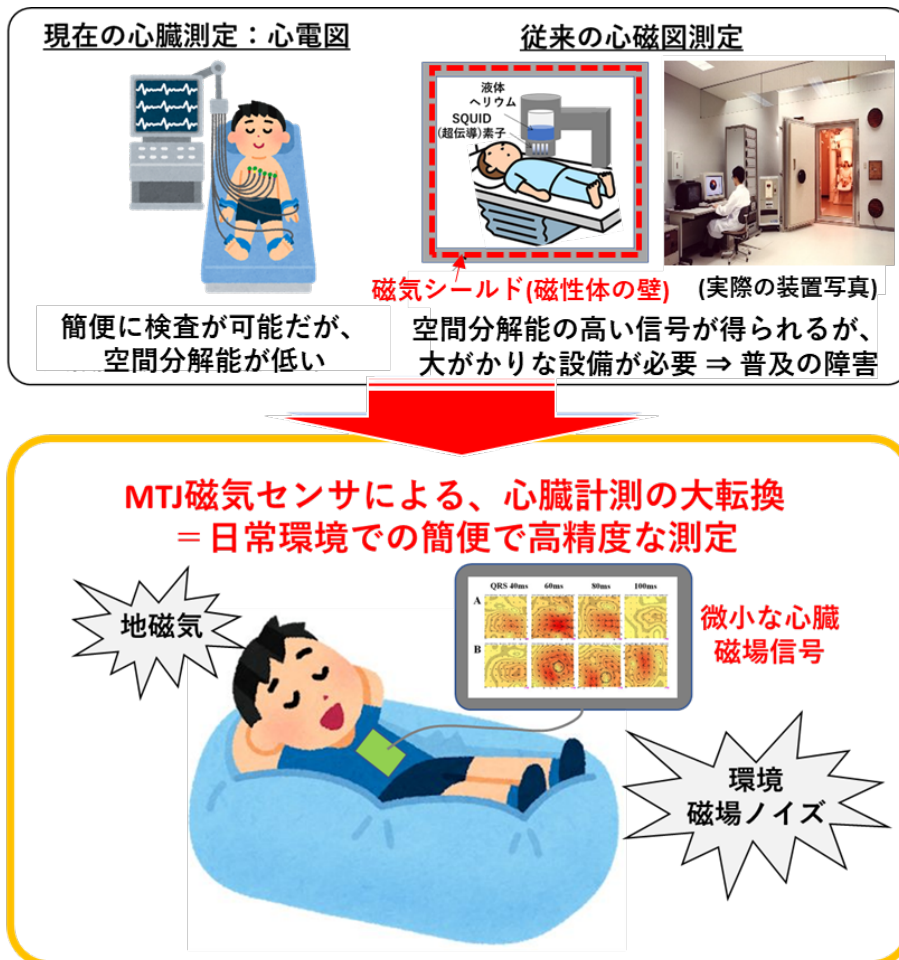
図 1 MTJ センサを用いた日常環境下における生体信号測定概念図
