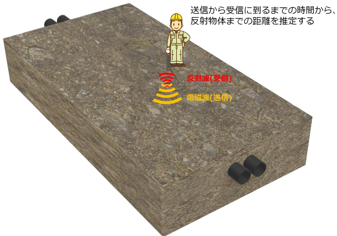
図1:電磁波による埋設位置推定方法(活用イメージ)
