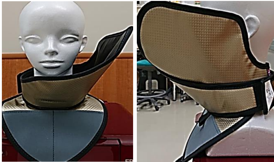
図1. IVR 術者用の新しい頭頸部用放射線防護具（フェイスシールド）の外観 左：正面像。甲状腺プロテクタ（ネックガード）とフェイスシールド部分を一体化して構成されている。フェイスシールドはIVR 術者の左側に設置してある。 右：新しい頭頸部用放射線防護具側面像。左側の側面像である。IVR 術者の左側からの散乱X線を効果的に遮蔽できるようにデザインされており、効果的に水晶体の放射線防護ができる。（IVR 術者の多くは、左側の被ばく線量が高い。）
