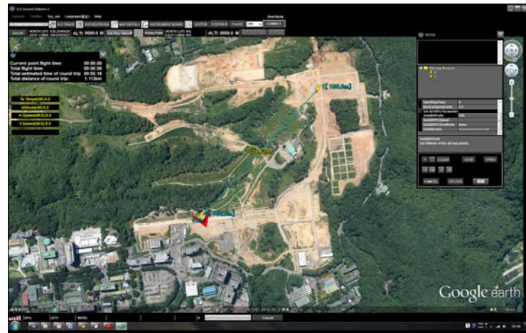
マルチコプターAの自律飛行設定画面
