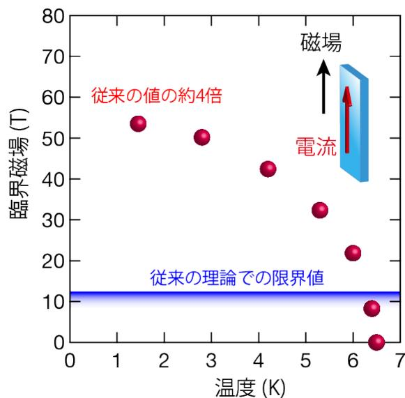
図2：MoS<sub>2</sub> -EDLT における面内磁場下における臨界磁場の温度依存性
