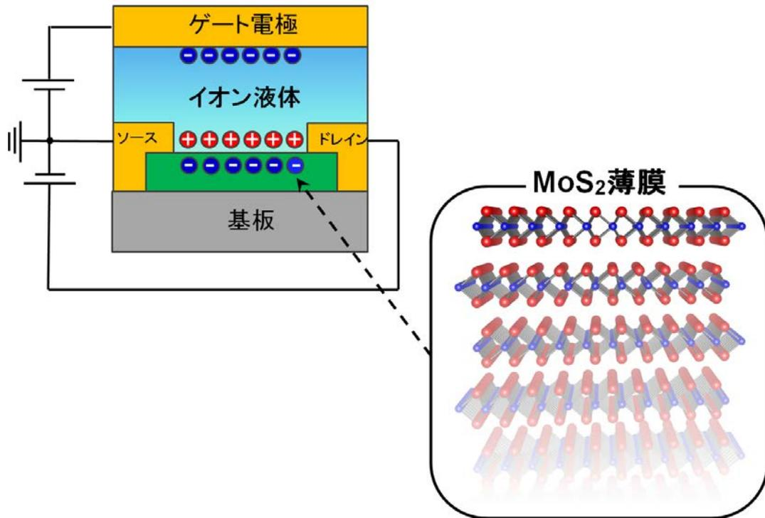
図1：二硫化モリブデン MoS<sub>2</sub>を用いた電気二重層トランジスタ構造
