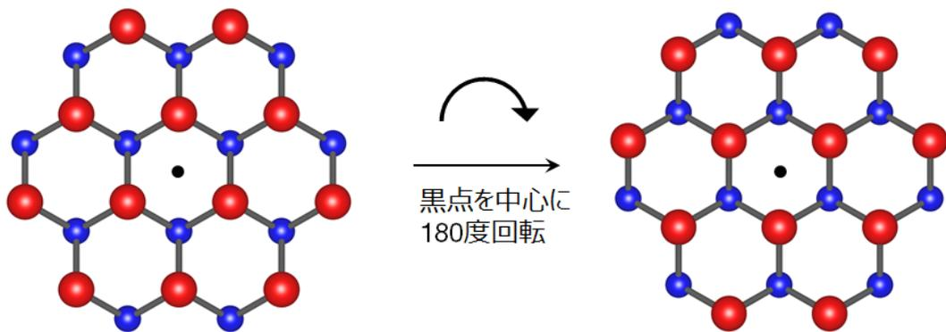
図3: MoS<sub>2</sub>の面内方向の反転対称性の破れ
