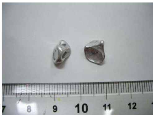
図1 ITOから本法を利用して回収したインジウム金属塊
